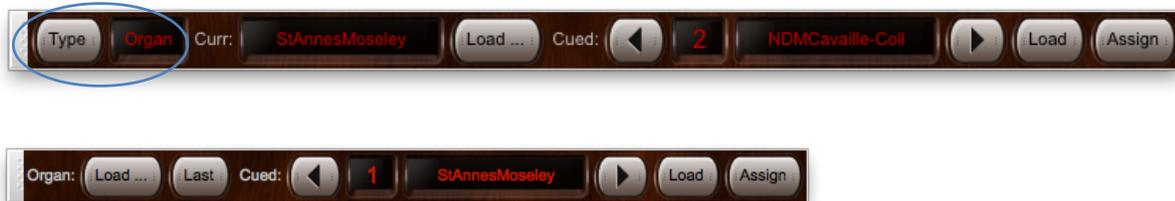
Les boutons des palettes de contrôle en forme de flèches droite-gauche font défiler les instruments mis en file d'attente dans la liste des trente-deux favoris, le bouton *Load* charge l'objet sélectionné dans la liste d'attente et le bouton *Assign* l'ajoute à la liste des favoris, sous le même numéro que celui qui est en file d'attente et dont l'assignation dans cette liste, sous ce numéro, va se trouver 'écrasée'.
