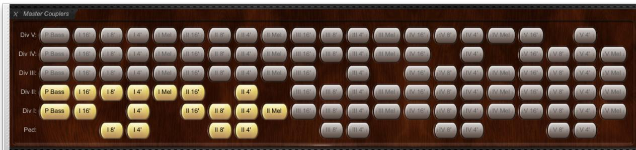
Si un instrument virtuel dispose de trois claviers, la rangée d'accouplements *Div III* va se trouver également disponible ; s'il en a quatre, s'y ajoutera la rangée *Div IV*, et ainsi de suite.
